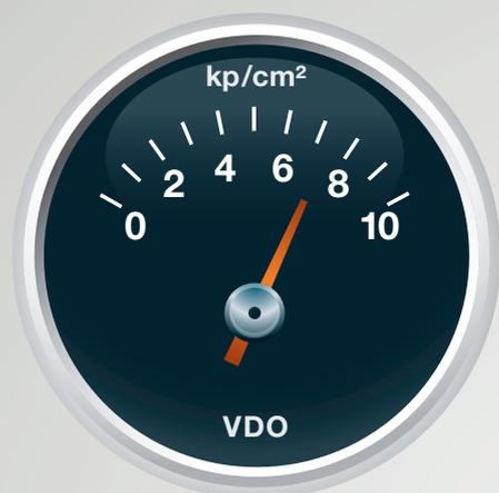
Если давление масла слишком высокое, то уплотнение соединений на корпусных деталях, масляные фильтры, масляные радиаторы и трубопроводы могут стать негерметичными или лопнуть.
