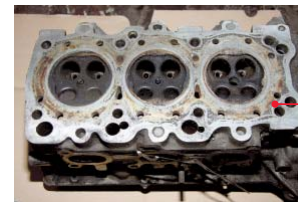
Одно из самых серьезных последствий езды со старым, «сработавшимся» и засоренным антифризом в системе – коррозия привалочной плоскости головки блока цилиндров.
