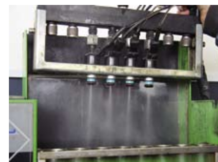
Наиболее правильная процедура чистки форсунок включает в себя контроль за их производительностью и качеством распыла до и после мойки.
