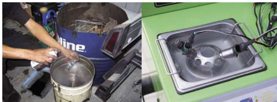
Наши «Кулибины» для мойки форсунок приновились использовать аэрозольные очистители карбюратора.
